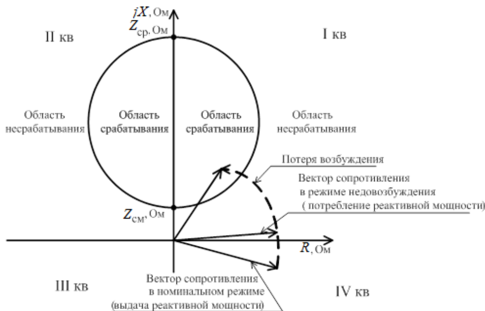
Рис. 9.2 Характеристика защиты электродвигателя СТД–4000–2 от потери возбуждения
