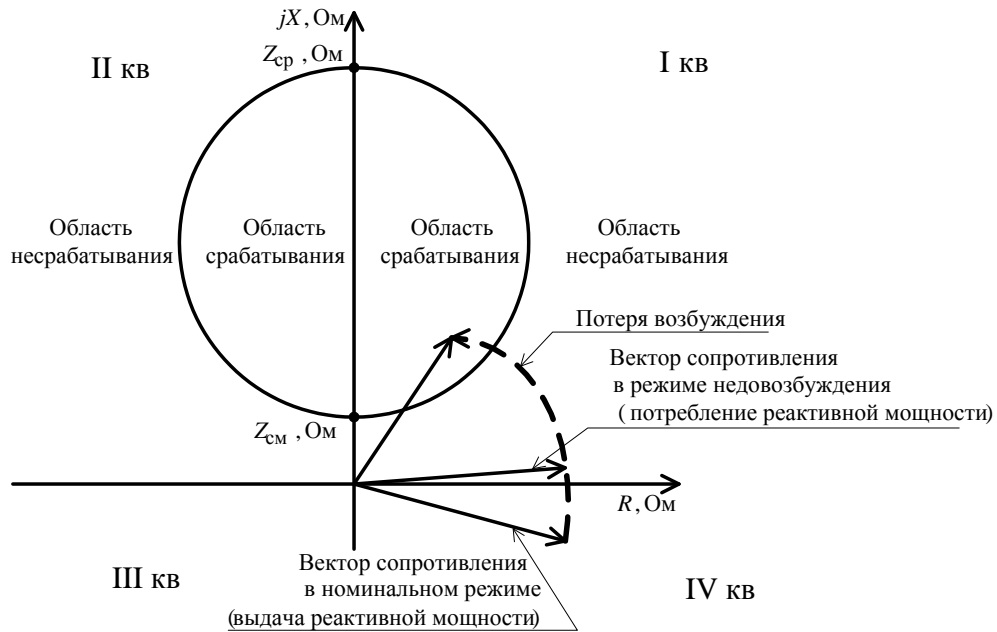
Рис. 9.1. Характеристика защиты электродвигателя от потери возбуждения
