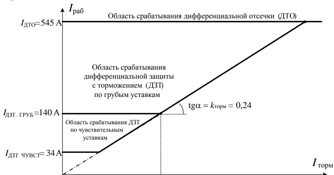
Рис. 2.6. Характеристика дифференциальной защиты двигателя серии А4 мощностью 1000 кВт с использованием ДЗТ с очувствлением
