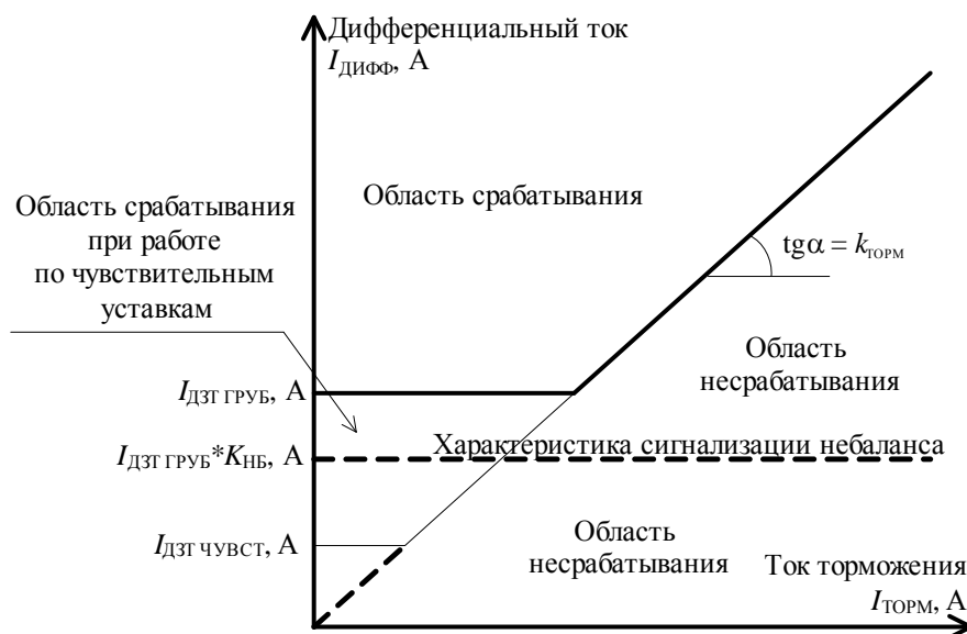
Рис. 2. 4. Характеристика работы ДЗТ электродвигателя с очувствлением
