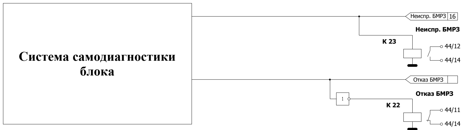
Рисунок Б.17 - Функциональная схема алгоритма самодиагностики блока
