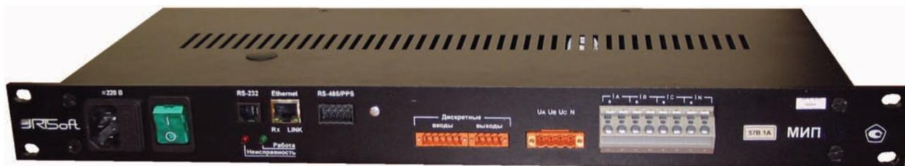
МИП-02-1х представляет собой устройство для векторных измерений параметров режима электрической сети (Phasor Measurement Unit — PMU) и предназначен для применения в составе систем WAMS (Wide Area Monitoring System), таких как:
