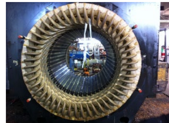
Общий вид лобовой части обмотки статора турбогенератора серии ТВВ: 1 – коллектор холодной воды, 2 – гибкие изолирующие шланги, 3 – коллектор горячей воды, 4 – водораспределительные шланги
