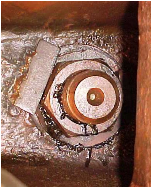
Ослабление затяжки гайки на стяжной призме сердечника статора
