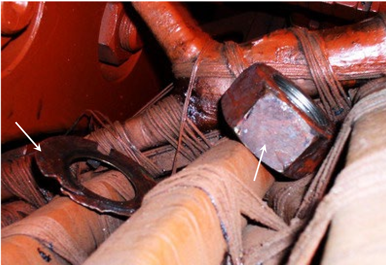
Гайка и стопорная шайба стяжной призмы сердечника, упавшие на обмотку статора
