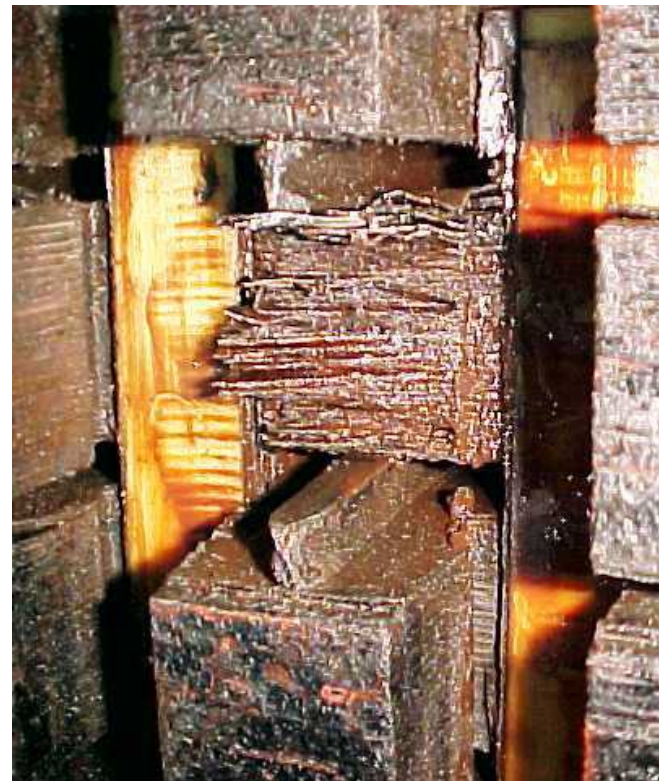
Выкрашивание пакета зубца сердечника, вследствие его распрессовки
