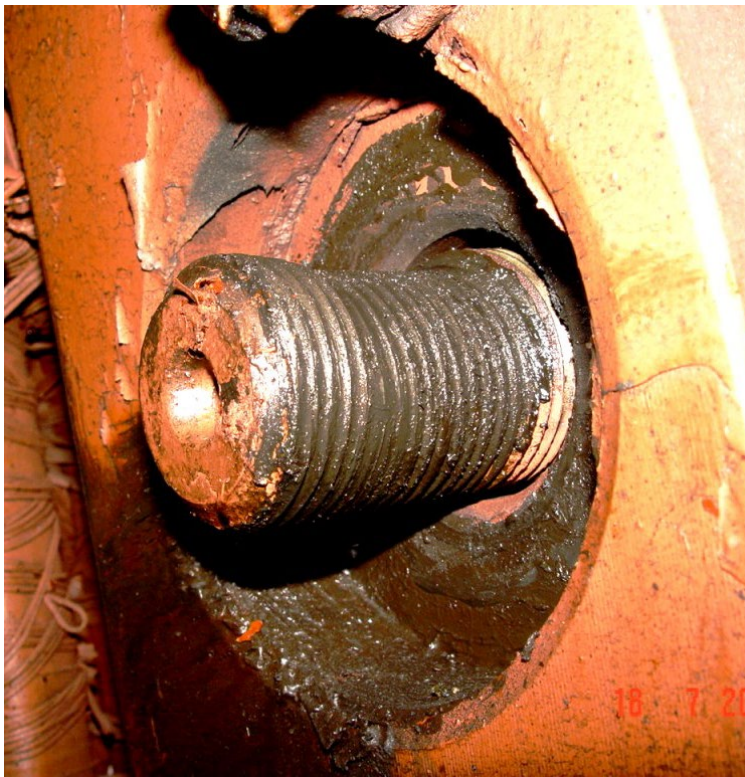
Резьба на стяжной призме сердечника, истёртая гайкой, затяжка которой была утрачена
