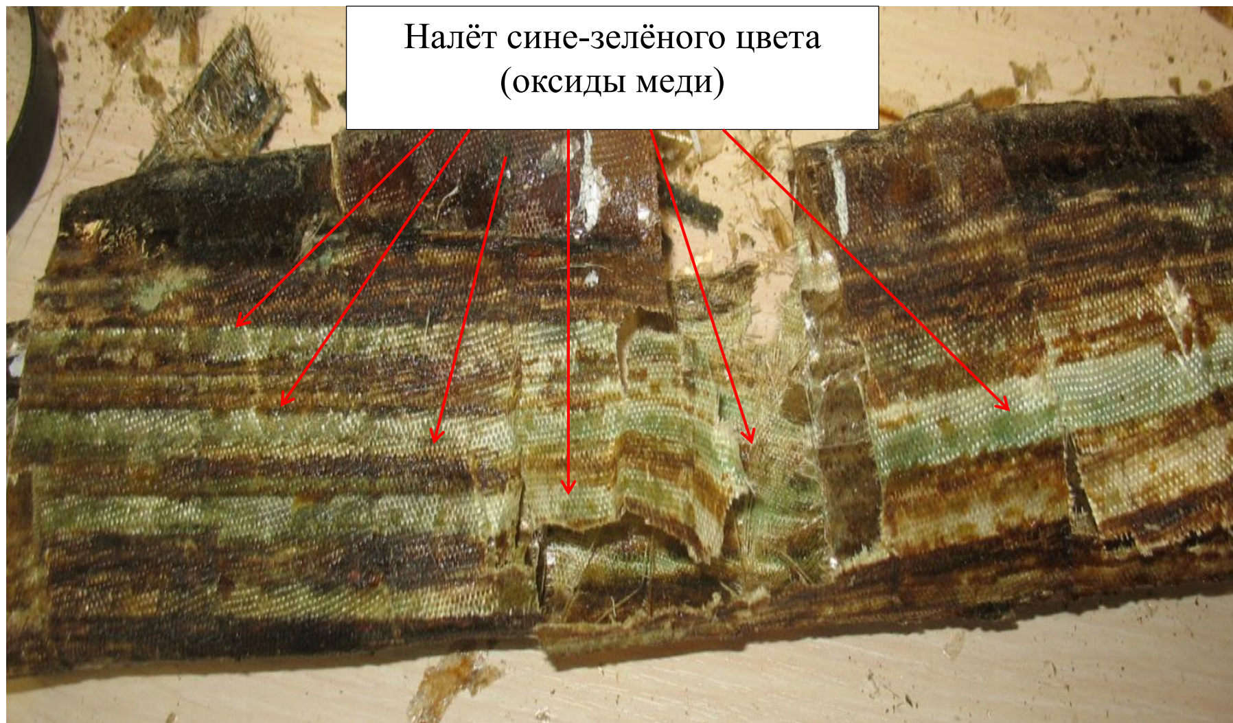
Общий вид внутренней поверхности корпусной изоляции первого «столбика» со стороны широкой грани.
