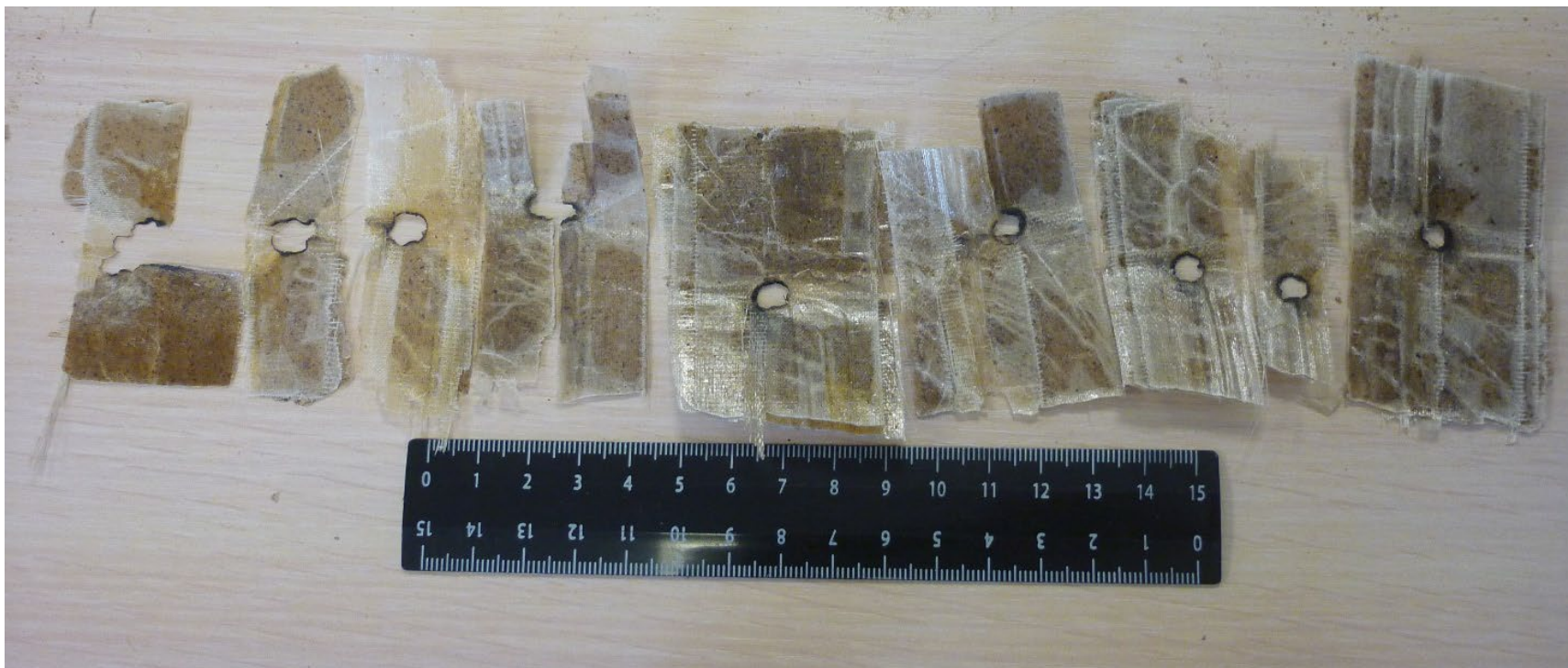
Фрагменты слоёв изоляции со следами пробоя.
