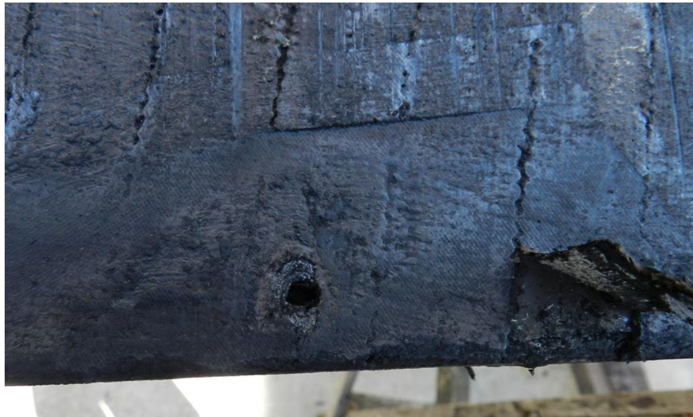
**Продавливание микалентной изоляции лобовых частей и бандажного кольца в турбогенераторе 165 МВт с водородно-водяным охлаждением.**
