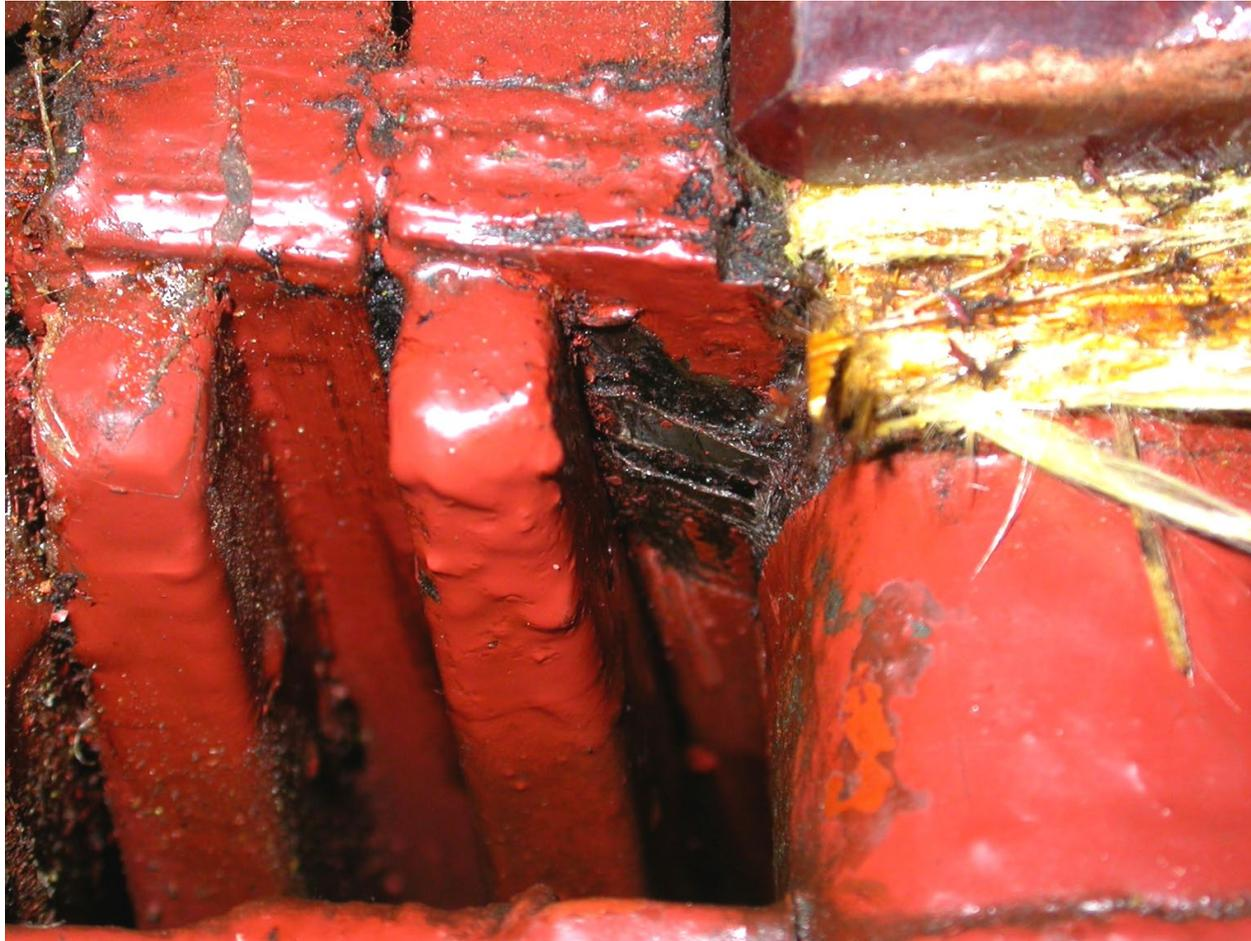
**Отверстие в изоляции стержня турбогенератора 165 МВт
