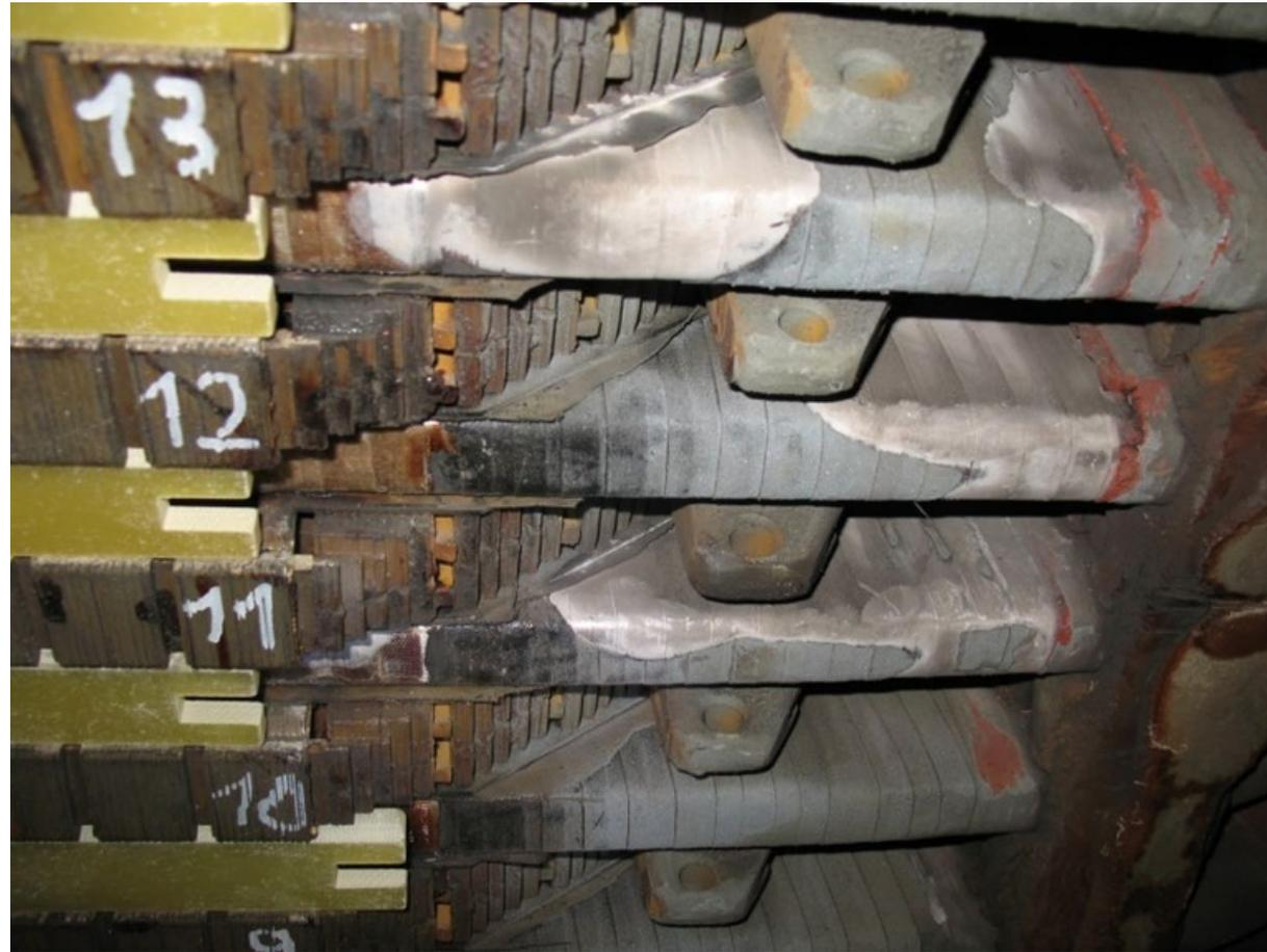
**Ионизационное разрушение изоляции в пазовой части
