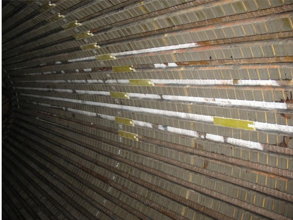
**Ионизационное разрушение изоляции в пазовой части
