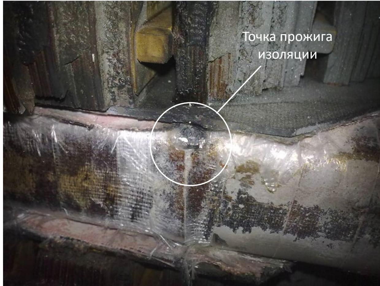
**Оплавление меди и стали статора в результате
