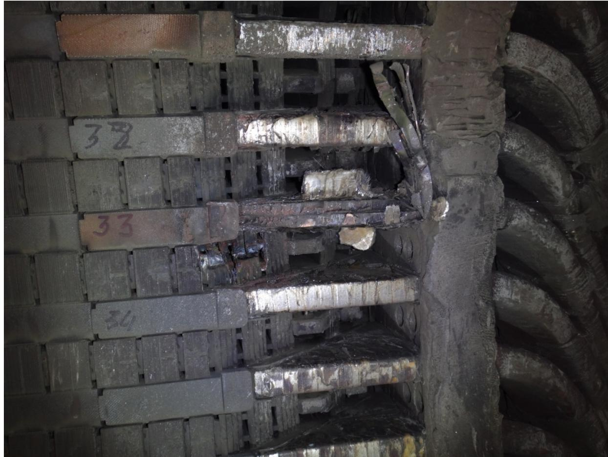
**Оплавление меди и стали статора в результате
