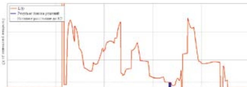
Рис. 3. Результат работы адаптивного алгоритма ДОМП при анализе неустойчивого КЗ
