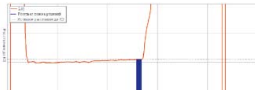
Рис. 4. Результат работы ДОМП при анализе аварии на ВЛ-110 кВ
